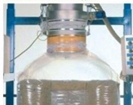
Придать формостабилизирующие свойства стандартному четырем строповому мягкому контейнеру позволяет использование формостабильного вкладыша.
